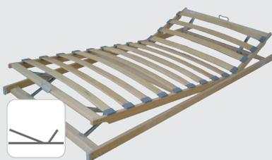
Manuell Kopf- und Fussteil verstellbarer Lattenrost. Beschlagstechnik: 4 TÜV/LGA-geprüfte Rasterbeschläge Federholzleisten (M-L:200cm): Mind 15 Stück klar lackiert (glue/glue; ca.52 mm breit). Endholm-Lagerung: LDPE - Kappen - angeschossen. Aussenrahmen und Innenrahmen (Schichtholz ca. 50x20mm): Klar lackiert (glue/glue). Gesamthöhe: ca. 6 cm. Haupt-Material: 1A-Qualitäts-Schichtholz. Fixmass - Toleranz: L:-5cm B:-1cm.
