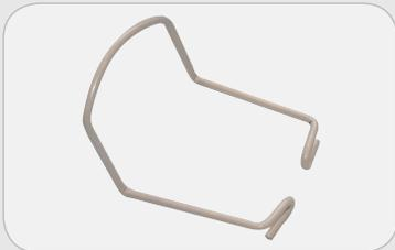
Matratzen-Halter (längs) aus Stahl-draht, welcher das verrutschen der Obermatratze verhindert und einfach - in Längsrichtung - in den Federholz-leisten eines Lattenrostes Fussteil einzuhängen ist. Dieser Matratzenhalter ist ausschließlich für alle Lattenrost - Typen mit Federholzleisten 35-40mm breit und 8mm stark (in Kautschuk-Duo-Kappen gelagert) geeignet.
